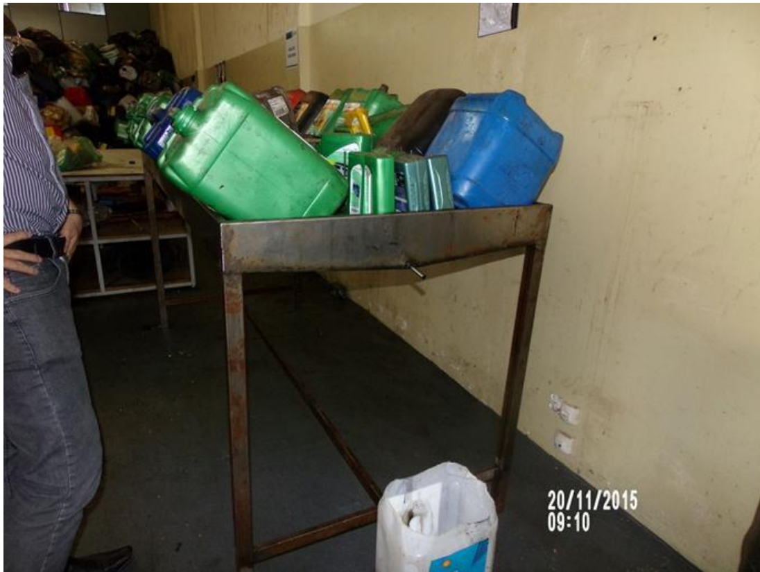
Figura 41: Mesa pingadora sem mangueira ligando ao recipiente Fonte: GRI-Uberlândia, 2015
