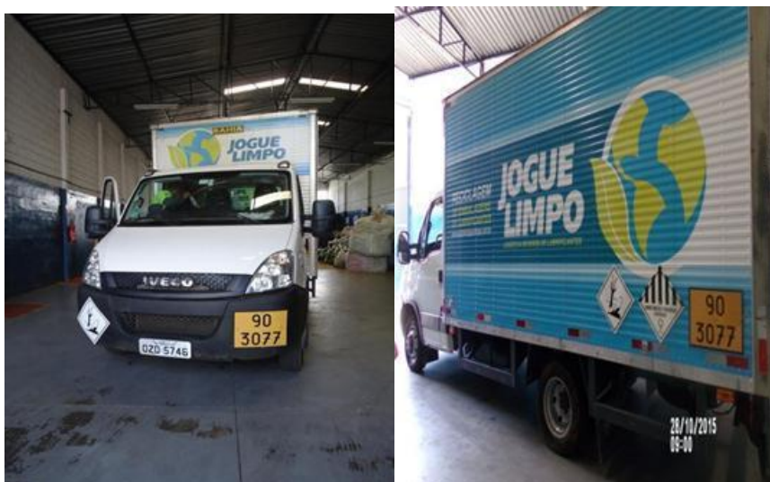
Figura 6: Caminhão do Programa devidamente sinalizado, segundo NBR 7500 Fonte: Programa Jogue Limpo, 2015
