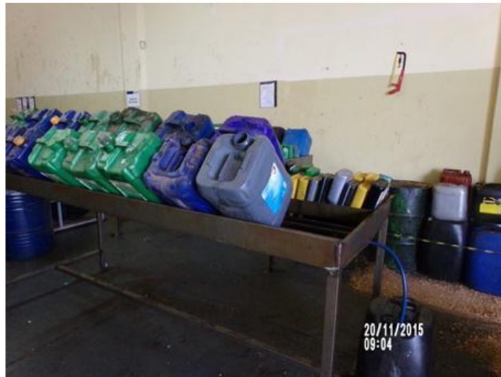
Figura 38: Mesa pingadora – drenagem do óleo Fonte: GRI-Uberlândia, 2015
