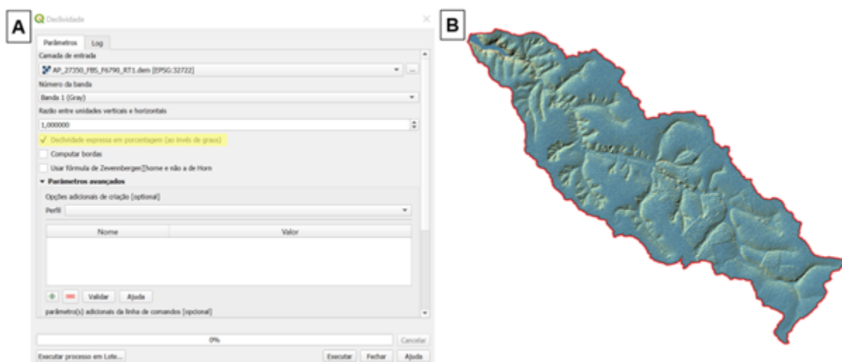
Figura XV - A caixa de diálogo do cálculo de declividade está representada em (A), com destaque, na cor amarela, para a expressão dos dados em porcentagem e não em graus. A camada de entrada é o raster recortado. Demais parâmetros não devem ser marcados nesta caixa. Clica-se em Executar para ter o produto representado em (B)
