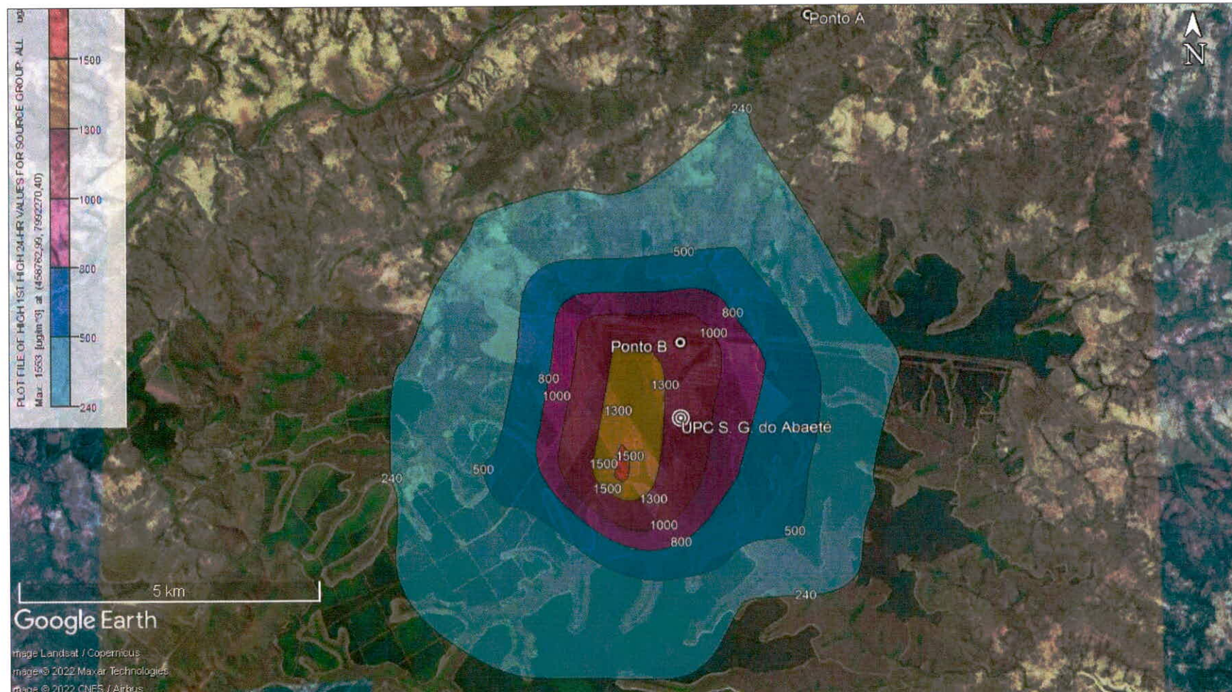
Figura 16 - Pluma da Modelagem UPC Município de São Gonçalo do Abaeté – 24H – Fator Emissão: 66,4kg/t
